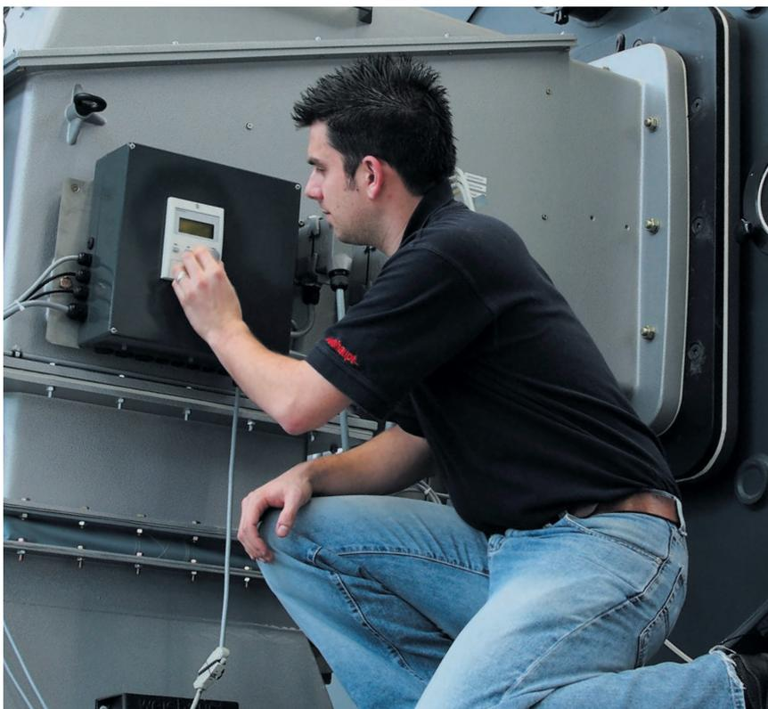
Ввод и контроль параметров с помощью блока управления и индикации
